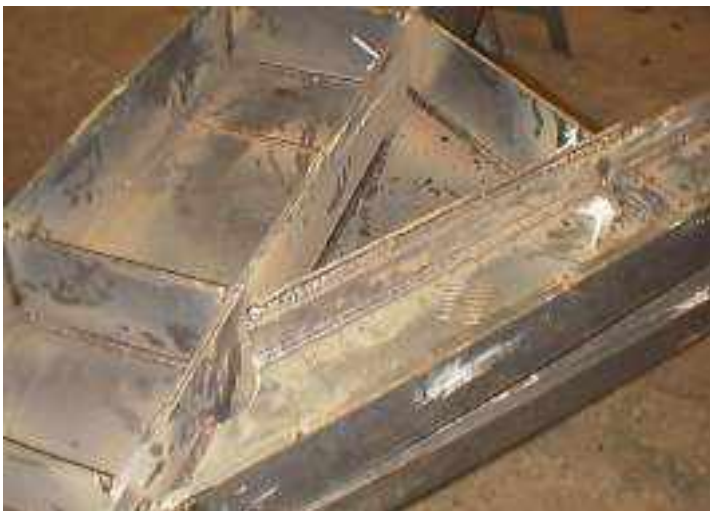
Tolvas en voladizo Para permitir el completo accionamiento de las tapas
