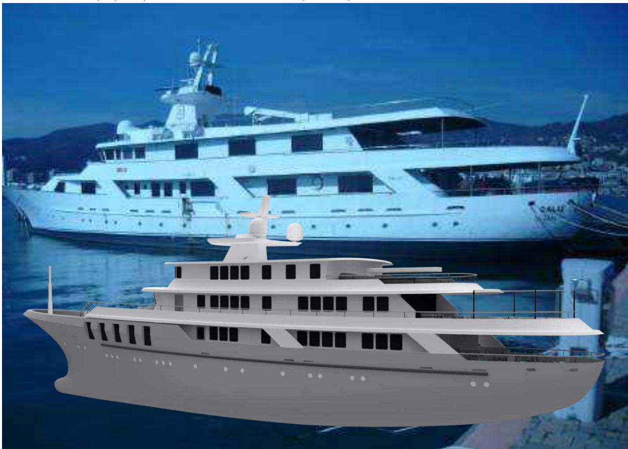
Embarcación original en Génova y render de la embarcación rediseñada (notar la proa y la cubierta adicional).
