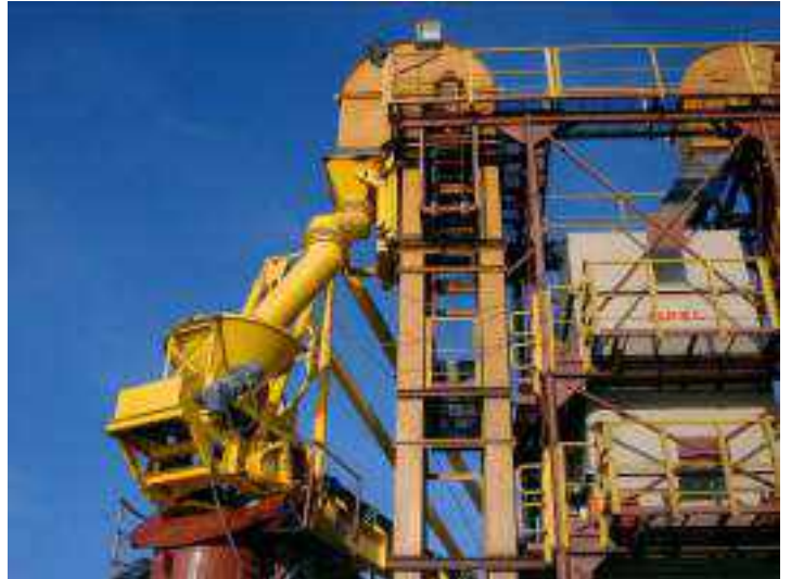
Torreta del brazo de descarga Análisis por elementos finitos. Diseño de toda la mecánica
