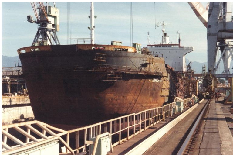
Sección de transición Notar la diferencia de puntales.
