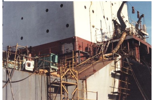
Sección de transición Notar la diferencia de puntales.
