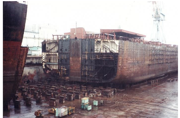
Sección proel de la Alianza G1, preparada para la unión
